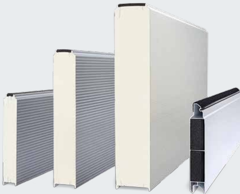
Thermisch getrennte, doppelwandige Stahl-Sandwich-Lamellen in drei Stärken: 42, 67 und 100 mm, Acoustic-Lamelle
