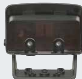
Radar- Bewegungsmelder MWD-C schnelle und gezielte automatische Toröffnung, richtungs- erkennend, max. Montagehöhe 7 m, Montage im Tiefkühl- bereich bis max. -22°C, IP 65
