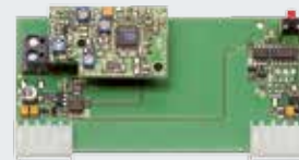
Empfänger HER 1 (1-Kanal) mit potentialfreiem Relais-Ausgang im separaten Gehäuse, ohne Anschluss- leitung oder als Aufsteck-Platine im Steuerschrank
